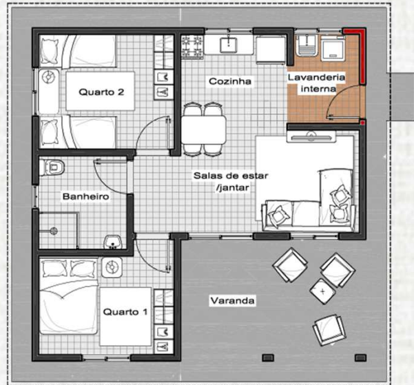
FECHAMENTO DA LAVANDERIA SEM AMPLIAÇÃO DE TELHADO
