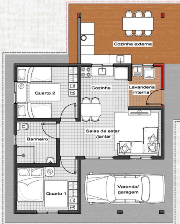
AMPLIAÇÃO DO TELHADO PARA EXECUÇÃO DE COZINHA EXTERNA COM FOGÃO A LENHA E FECHAMENTO DA LAVANDERIA
