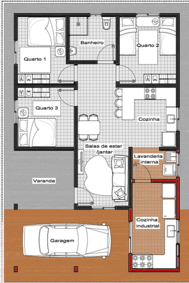
AMPLIAÇÃO DO TELhado PARA EXECUÇÃO DE GARAGEM, ESPAÇO DE TRABALHO E PRODUÇÃO E FECHAMENTO DA LAVANDERIA
